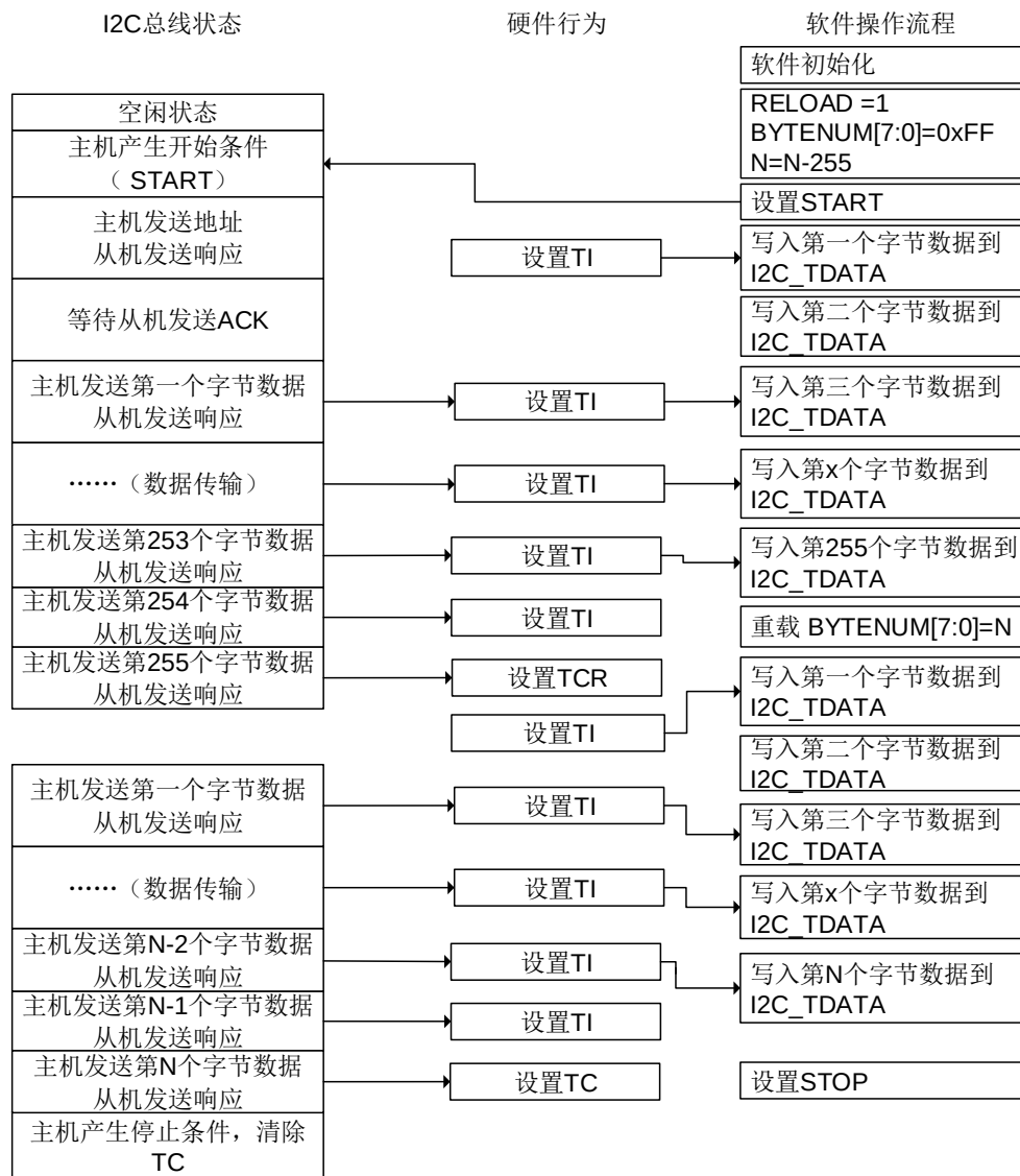
图 17-19. I2C 主机发送编程模型 (N&gt;255)
