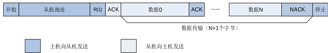
图 17-6. 7 位地址的 I2C 通讯流程（主机接收）
