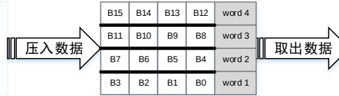
图 10-4. PWIDTH 为‘0b00’时，数据的打包 / 解包
