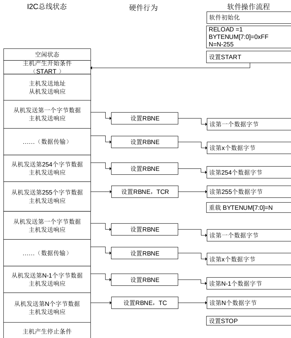
图 17-21. I2C 主机接收编程模型 (N&gt;255)
