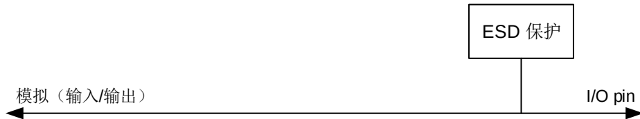
图 7-4. 模拟配置的基本结构
